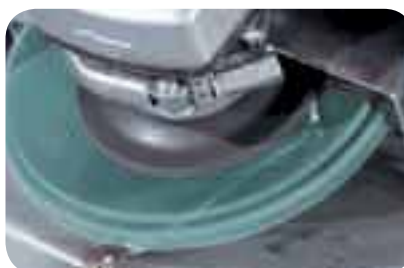
LSZ F VISION dzięki trzem sprytnym wycięciom umożliwia obserwację obrabianego przedmiotu.
